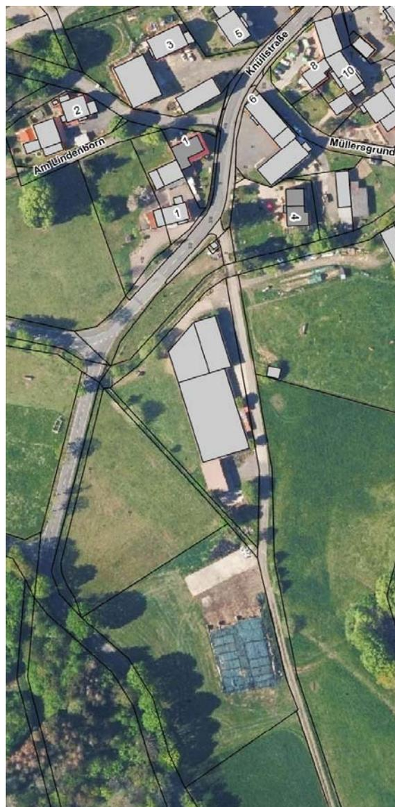
Gebäudekomplexes ist die Betriebsfläche bis zur Gewässerparzelle gepflastert. Im Süden wurde eine Teilfläche betoniert. In der südlichen Spitze des Grundstücks besteht eine höherliegende, geschotterte Lagerfläche, die durch eine Stützmauer begrenzt wird.
